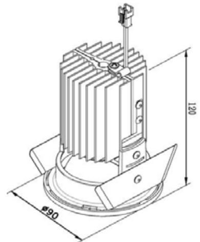
Einbau-Strahler rund fix, mit Bajonettverschluss, direktstrahlend, Diffusor opal, Gehäuse aus Alu-Druckguss mit Abdeckrand, rund
