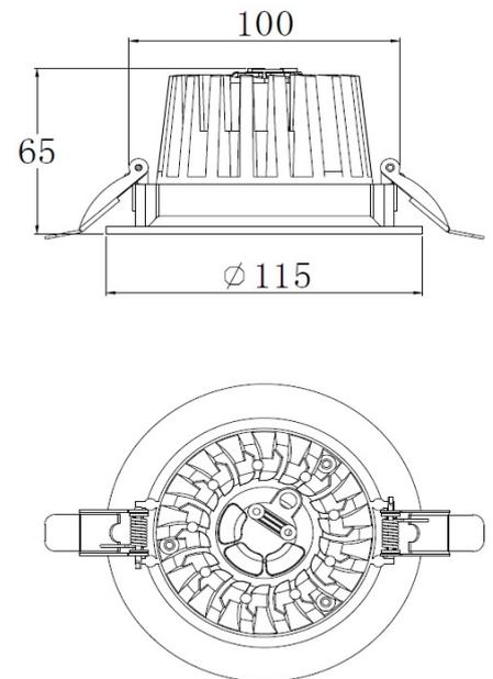
Einbau-Strahler rund , direktstrahlend, Gehäuse aus Alu-Druckguss mit Abdeckrand, rund.
